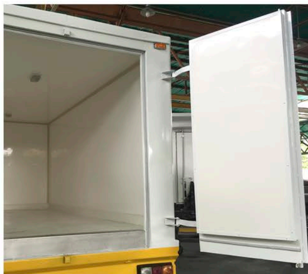
Puerta de acceso adaptada con aislamiento térmico y gomas de sello.
