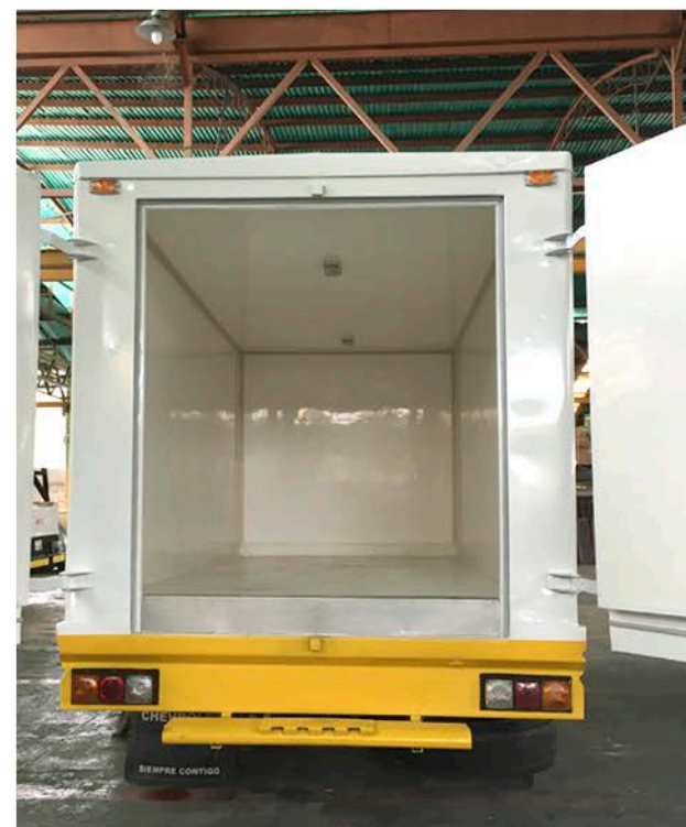
Furgón de aluminio convertido en cava isotérmica.
